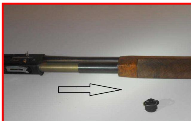
3. sfilare il tiretto d'armamento dell'otturatore
