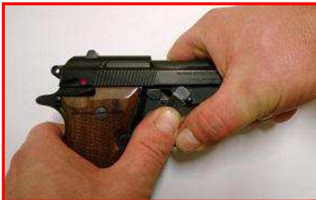
4. Sfilare in avanti, nel senso della freccia, il complesso carrello otturatore/canna/molla di recupero che si separerà dal fusto. Una volta estratto togliere la molla di recupero con la relativa asta guida molla dalla propria sede.
