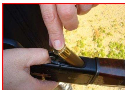
2. Ruotare il fucile verso destra per favorire l'espulsione della cartuccia camerata poi con il taglio della mano sinistra, spingere sulla tiretto di armamento ed arretrare l'otturatore recuperando la cartuccia con la mano destra.
