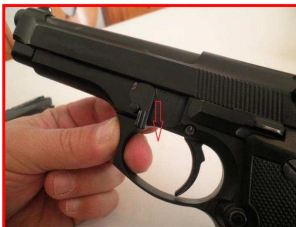
3. Sfilare in avanti, nel senso della freccia, il complesso carrello otturatore/canna/molla di recupero che si separerà dal fusto.
