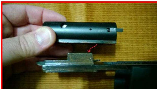
6. Il gruppo otturatore con in evidenza il percussore corredato della relativa molla di richiamo. A destra si noti l'unghia estraottrice ed il foro della sede del percussore. ¶ el momento dello sparo il percussore fuoriesce dalla sua sede e percuote l'apparecchio d'innesco della munizione dando il via a tutto il processo chimico fisico che determina la partenza del colpo.
