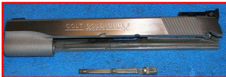
*L'unghia estrartrice interna ed il carrello otturatore di una Colt 1911*
