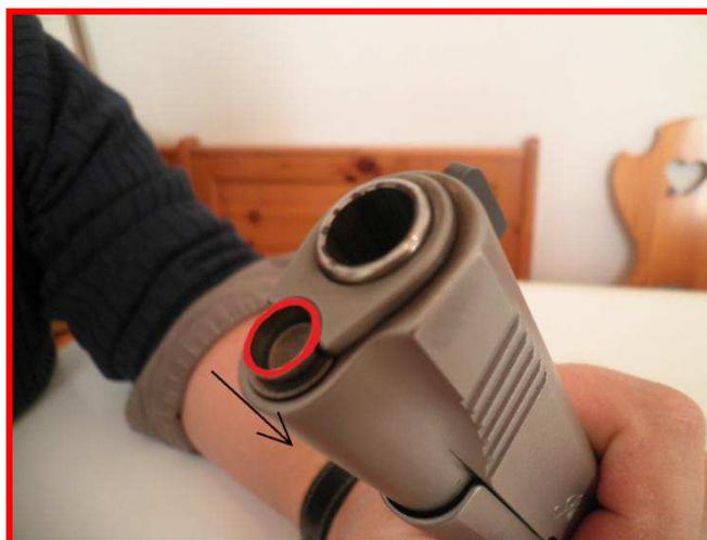
2. Ruotare la bussola (bushing) in senso orario come indicato dalla freccia prestando attenzione che il tubetto reggispinga e la molla di recupero, sotto l'azione della stessa molla, non fuoriescano violentemente; è buona norma mentre si gira il bushing tenere un dito sul tubetto reggispinga che si libererà non appena la bussola sarà a fine corsa.
