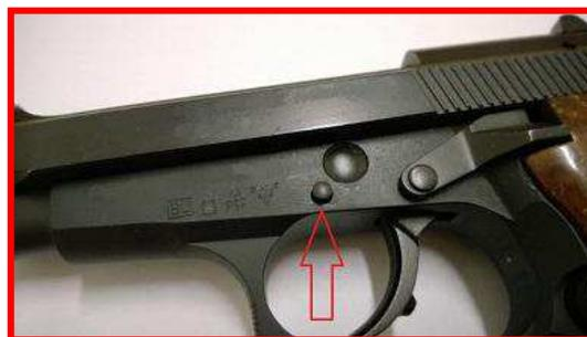
2. Ruotare in senso antiorario, verso il basso il chiavistello di fissaggio indicato dalla freccia. Il complesso carrello otturatore/canna/molla recupero si libererà e potrà scorrere in avanti.
