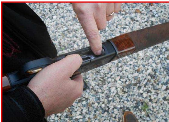
2. Riportare il fucile in posizione, arretrare l'otturatore bloccandolo in apertura al fine di ispezionare la camera di cartuccia visivamente e tattilmente
