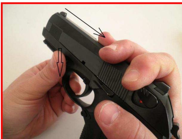
2. Sfilare in avanti, nel senso della freccia, il carrello otturatore che si separa dal fusto.
