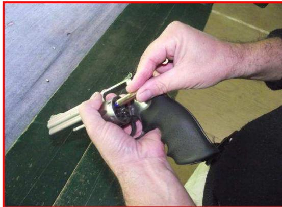
3. Una volta caricato il tamburo spingerlo all'interno del castello assicurandosi del suo bloccaggio e del corretto allineamento della camera di scoppio con la canna.
