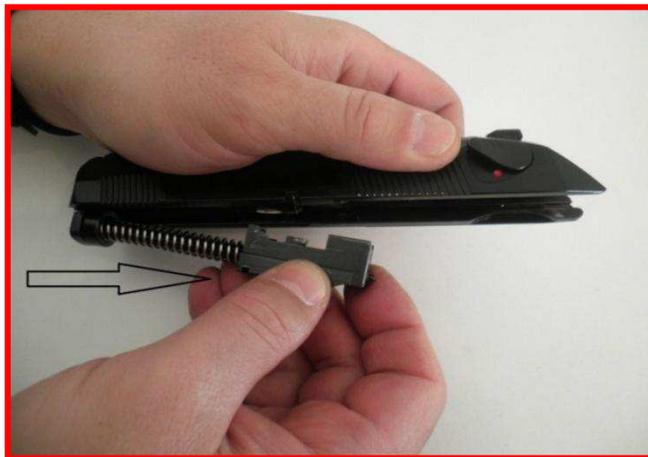
4. Sfilare, inclinando verso il basso, la canna eseguendo una leggera rotazione della stessa in senso antiorario con volata rivolta in avanti.
