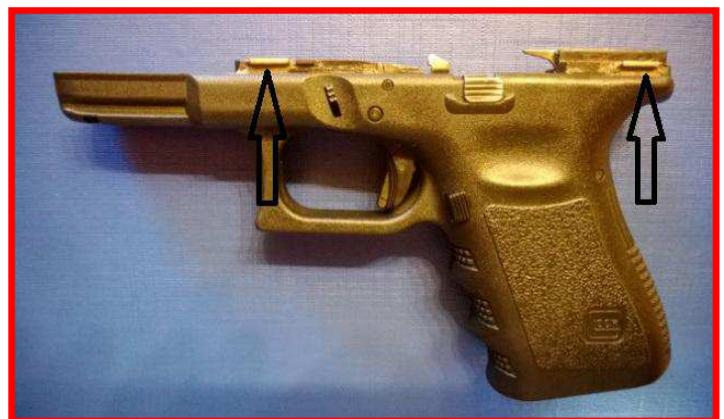
*In foto a sinistra un fusto in acciaio ed a destra un fusto in tecnopolimero: da osservare che le guide di scorrimento del carrello sono state realizzate con inserti di acciaio annegati nel fusto in polimero per conferire la giusta solidità e robustezza all'insieme.*
