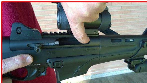
*E' buona norma, per evitare chiusure accidentali dell'otturatore, e quindi ferimenti al dito, mantenere in posizione bloccata l'otturatore con la mano che non esegue il chamber check (nella foto si è omesso per evidenziare il particolare del controllo tattile col dito)*
