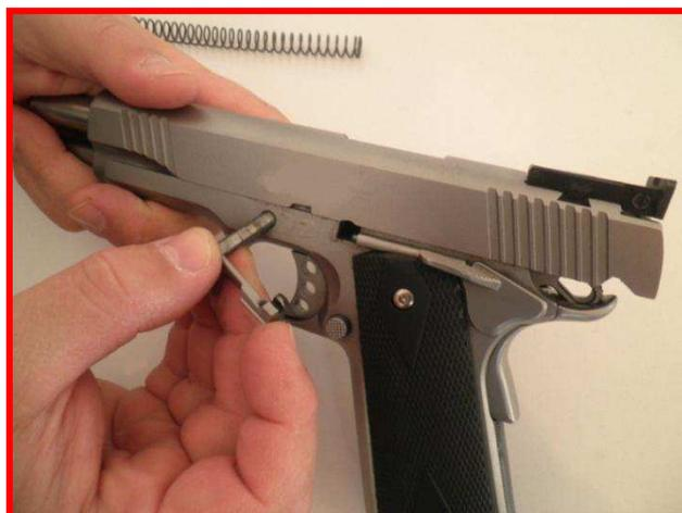
7. Sfilare il carrello otturatore secondo il senso della freccia. In evidenza si vede l'asta guidamolla senza la molla già sfilata dal davanti. L'asta guidamolla si sfila dall'interno del carrello.
