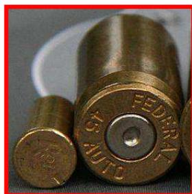
Comparazione fra il bossolo di una munizione rimfire in calibro .22Lr, a sinistra ed il bossolo di una munizione centerfire in calibro .45AC9 a destra. Si noti l'impronta del percussore centralmente posizionata sul bossolo centerfire.
