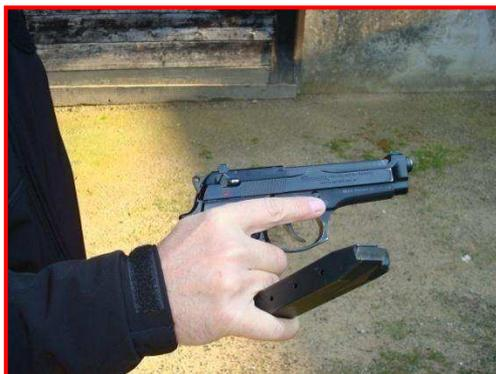
3. Ruotare il polso, arretrare il carrello otturatore e bloccarlo in apertura mediante l'uso della leva di blocco/sblocco del carrello.
