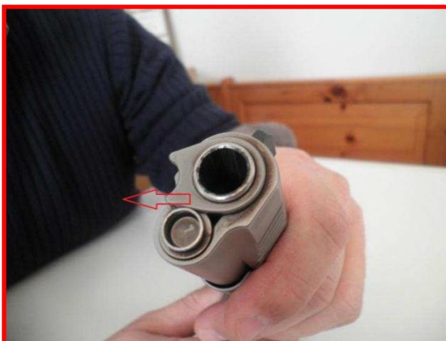
3. Nel particolare è evidenziata la molla con il relativo tubetto reggispinga. La freccia indica il verso dal quale fuoriescono i due componenti. A questo punto il carrello otturatore non è più sotto la tensione della molla di recupero e si può muovere senza sforzo, dopo aver armato il cane.
