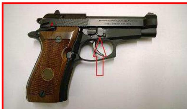
3. In foto l'operazione di rotazione del chiavistello di fissaggio.
