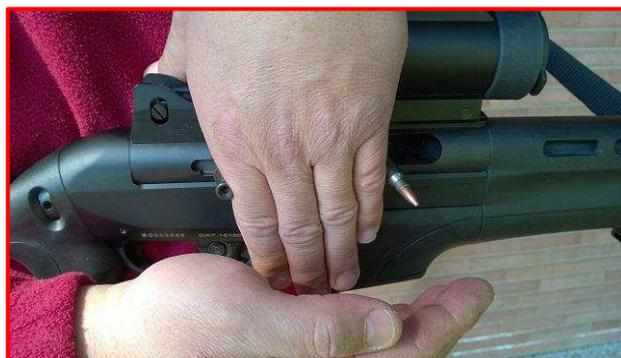
*E' buona norma, per evitare chiusure accidentali dell'otturatore, mantenere in posizione bloccata l'otturatore con la mano che non esegue il chamber check (nella foto si è omesso per evidenziare il particolare del controllo tattile col dito)*
