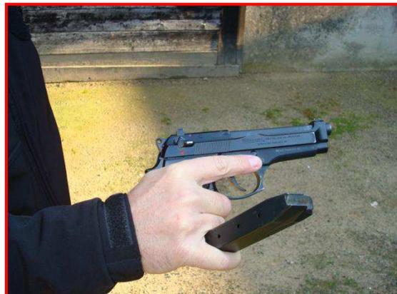
3. Verificare l'assenza del caricatore inserendo un dito all'interno del vano impugnatura
