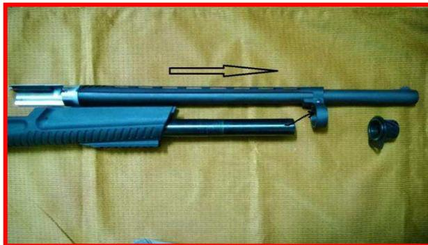
3. Sfilare, sempre nel senso indicato dalla freccia l'astina di armamento. Si noti in A l'incavo, ricavato nella canna, nel quale il rampone di chiusura si inserisce a fare tenuta evitando l'apertura dell'otturatore nel momento dello sparo. A destra il rampone incastrato come evidenziato dalla freccia.
