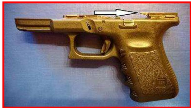
*L'espulsore in due differenti tipi di arma*
