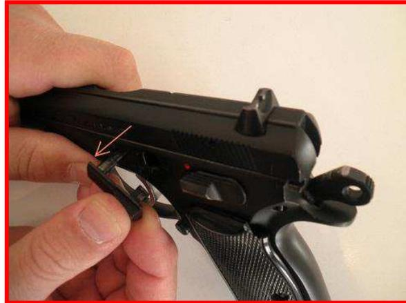
3. Sfilare lungo le guide il carrello otturatore. In evidenza in basso il chiavistello di smontaggio che spesso coincide anche con la leva di blocco/sblocco del carrello (slide stop). Si noti la molla di recupero che andrà sfilata prima di estrarre la canna.
