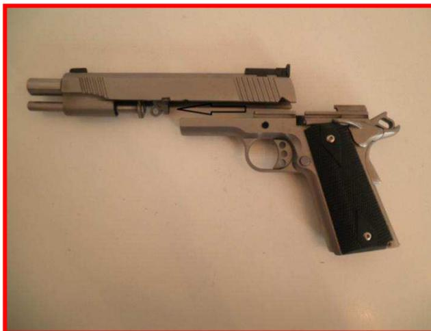
8. Ruotare la bussola (bushing), precedentemente ruotato in senso orario, in senso antiorario fino a fine corsa ed estrarlo dalla sua sede. Questa operazione svincola la canna dal carrello otturatore.
