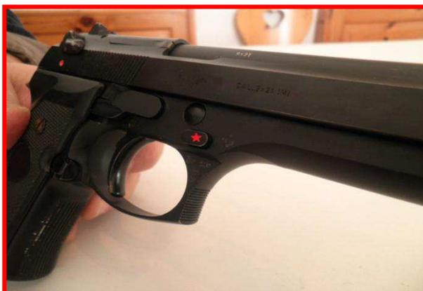
2. Ruotare in senso orario, verso il basso il chiavistello di fissaggio. Il complesso carrello otturatore/canna/molla recupero si libererà e potrà scorrere in avanti.
