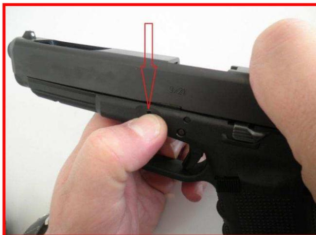
3. Sfilare, nel senso della freccia, il complesso carrello otturatore/canna/molla di recupero facendolo scorrere lungo le guide. Estrarre la molla di recupero visibile in foto.
