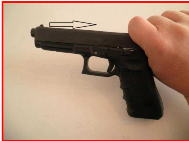
2. I mantenendo il carrello-otturatore arretrato, abbassare il suo fermo, per svincolarlo dal fusto.
